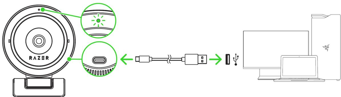
**i** Afin d'optimiser la diffusion en streaming et les enregistrements de votre caméra, nous vous recommandons vivement de connecter directement le périphérique à un port USB 3.0 de votre PC. La connexion du périphérique à un port USB 2.0, un hub USB, un interrupteur ou une rallonge pourrait nuire à son rendement.
