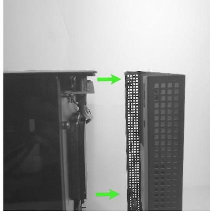
2. 打開兩側的可拆式轉軸玻璃門板，往上抬起即可取下玻璃門板。
