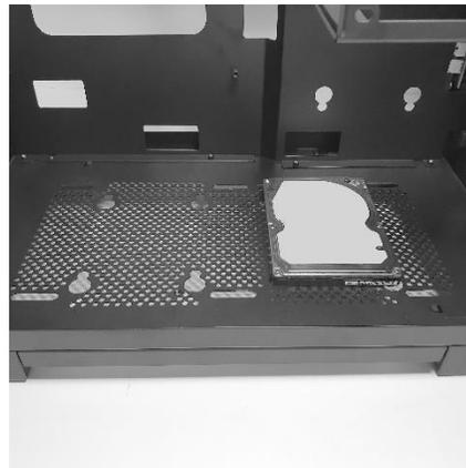
另外還可在機箱外側的側面安裝一顆磁碟機。
