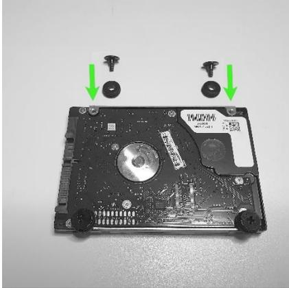
你最多可在機箱內側的底部安裝兩顆 2.5 吋磁碟機，
