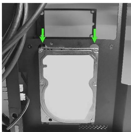
然後將隨附的指旋螺絲鎖入磁碟機後方，以固定磁碟機位置。
