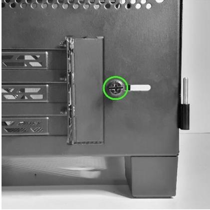
將螺絲往右滑動即可打開面板，接著鎖緊螺絲，將螺絲固定在定位。
