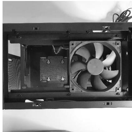
機箱內側的底部最多可安裝兩個 120mm 大小的風扇。
