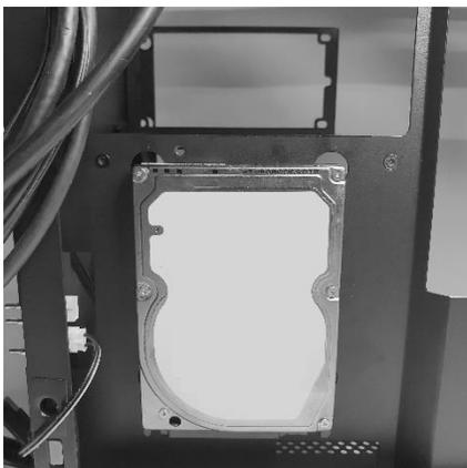
若要安裝硬碟，請在安裝孔之間放入防震環，接著將磁碟機滑入定位。
