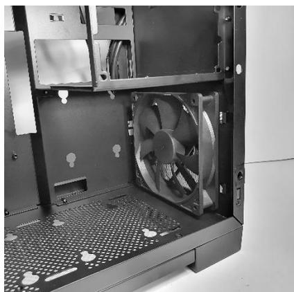
後方最多可以放入一個 120mm 大小的散熱器和風扇。
