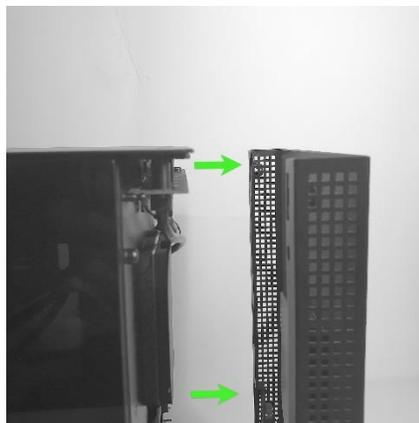
2. Откройте обе съемные поворотные стеклянные дверцы, а затем поднимите их, чтобы снять.
