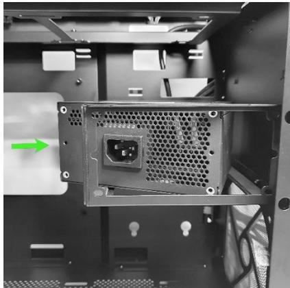
Зафиксируйте его с помощью прилагаемых винтов.
