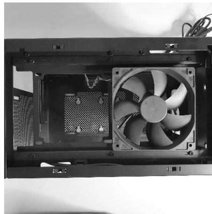
На нижнюю поверхность внутри корпуса можно установить до двух вентиляторов размером 120 мм.
