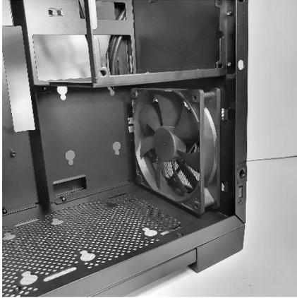
На задней панели можно установить радиатор и вентилятор размером до 120 мм.
