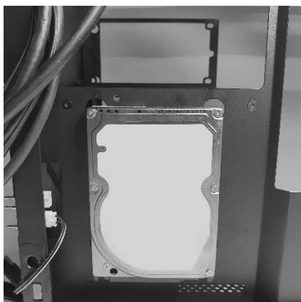
Para montar uma unidade, posicione os anéis antivibração entre os furos de montagem e, em seguida, deslize a unidade para fixá-la no lugar certo.
