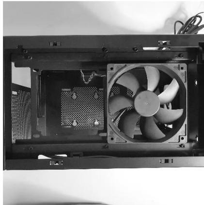
Na parte interna inferior do gabinete, podem ser montadas até duas ventoinhas de 120 mm.
