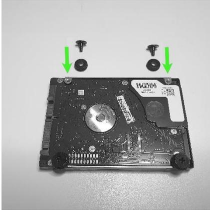
Du kannst bis zu zwei 2,5-Zoll-Laufwerke unten im Gehäuse unterbringen.
