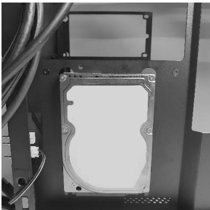
Para montar un disco, coloca las arandelas antivibración entre los orificios de montaje y, a continuación, desliza el disco para colocarlo en su sitio.
