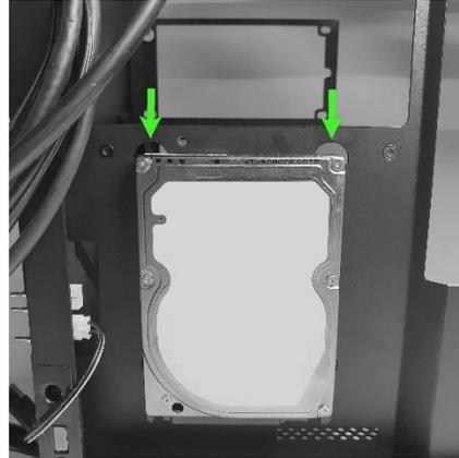
Después, para fijar el disco en su sitio, coloca el tornillo de cabeza moleteada que se incluye.
