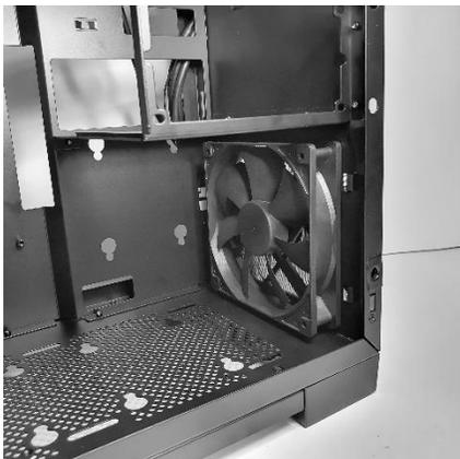
La parte trasera puede alojar un radiador y ventilador de hasta 120 mm.
