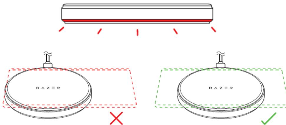
3. Bitte warte, bis dein Smartphone voll aufgeladen ist. Die Ladestation wird sanft in Razer Green pulsieren, damit du weißt, dass der Ladevorgang abgeschlossen ist.
