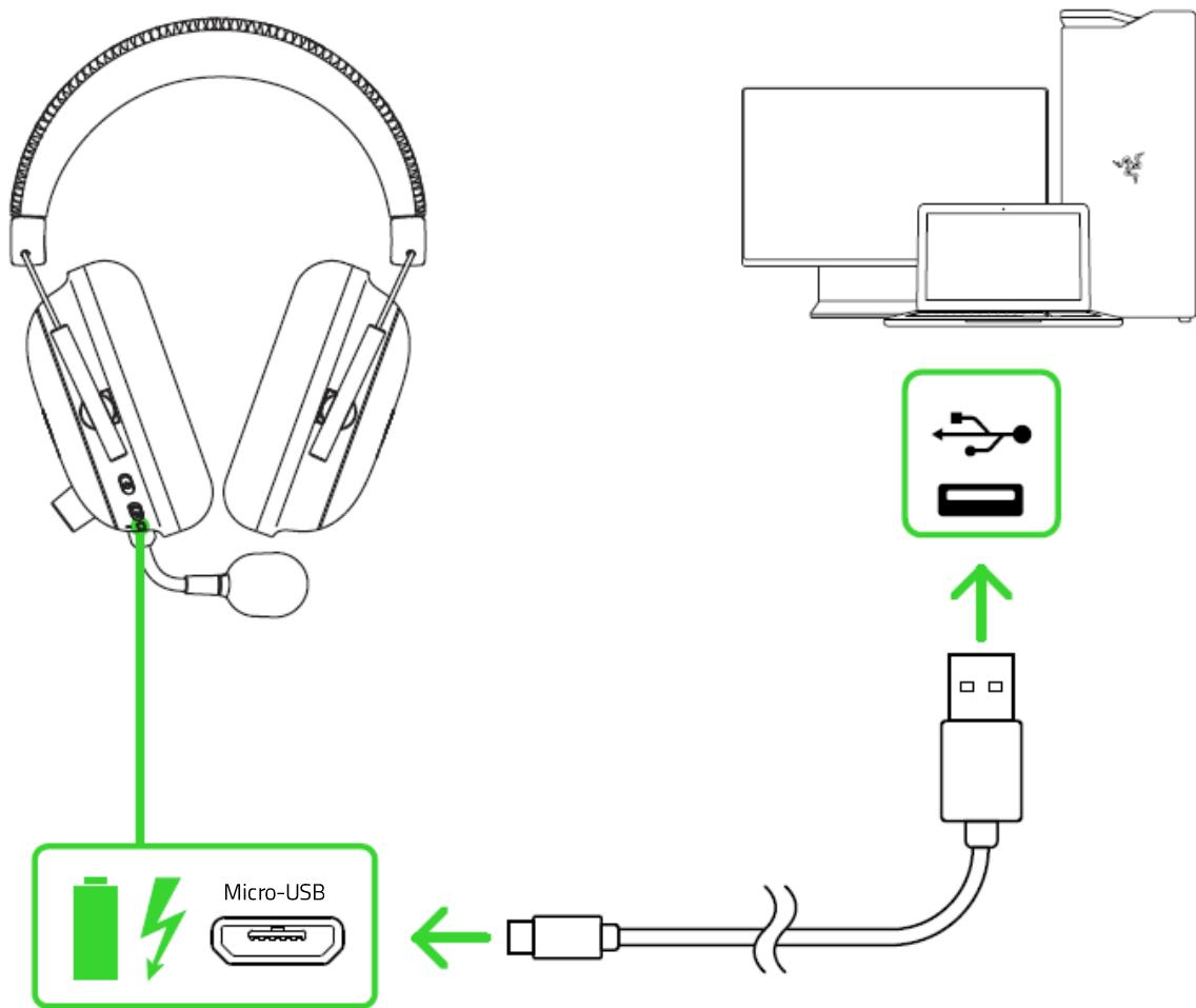
Для наилучшего результата полностью зарядите гарнитуру, прежде чем использовать ее в первый раз. Зарядка полностью разряженного аккумулятора длится приблизительно 3 часа.
