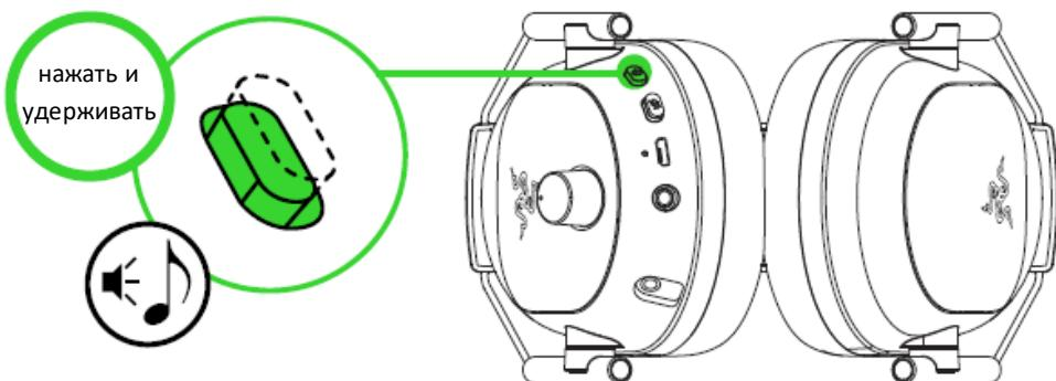
3. Подождите, пока индикатор состояния не загорится синим на короткое время, указывая на то, что гарнитура подключена к беспроводному USB-приемопередатчику.
