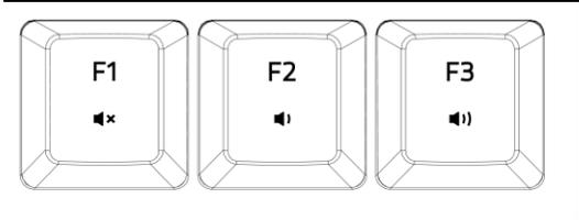
Three keyboard keys labeled F1, F2, and F3. F1 has a speaker icon with an 'x' (mute), F2 has a speaker icon (volume down), and F3 has a speaker icon with a vertical line (volume up). | 音量コントロールキーによって、オーディオ出力のミュート (🔇) や、音量を下げる (🔊) 、または上げる (🔊) ことができます。                            |
