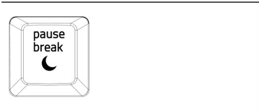
A keyboard key labeled "pause break" with a crescent moon icon below the text.                                                                                                       | スリープボタンでは、オペレーティングシステムのすべてのアクティビティを一時中断することができます。この機能を使用して、コンピュータがアイドル状態のときに、電気を節約することができます。 |
