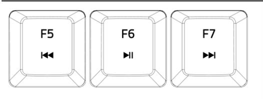
Three keyboard keys labeled F5, F6, and F7. F5 has a double left arrow (previous track), F6 has a play/pause icon (play/pause), and F7 has a double right arrow (next track).         | メディアキーによって、トラックの再生/一時停止 (▶  ) や、次のトラックへ進む (⏮) または前のトラックへ戻る (⏭) ことができます。                      |
