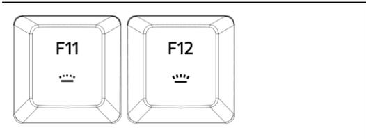
Two keyboard keys labeled F11 and F12. Both have a crown icon (LED control).                                                                                                         | バックライトコントロールキーにより、キーボードの LED を上げたり (👑) 下げたり (👑) できます。                                        |
