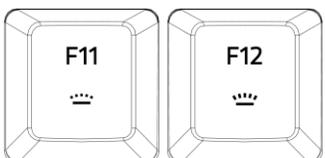
Two keyboard keys: F11 with a crown icon, and F12 with a crown icon.                                                    | 借助背光控制键，您可以降低 (👦) 或提高 (👦) 键盘 LED 的亮度。            |
