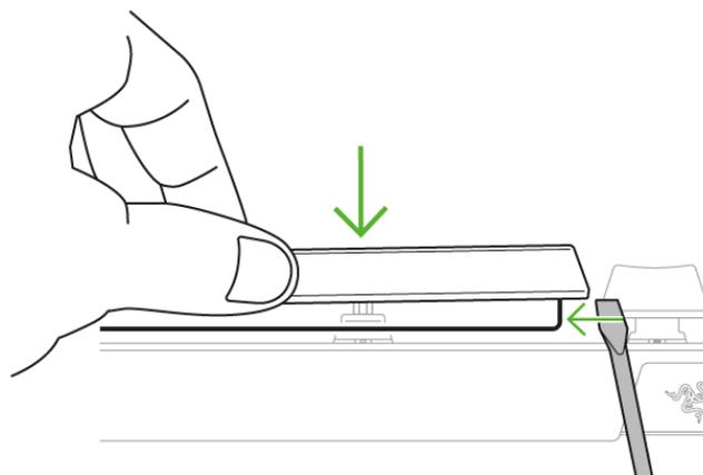
3. Presiona con firmeza la tecla de PBT Razer hasta que quede colocada.
