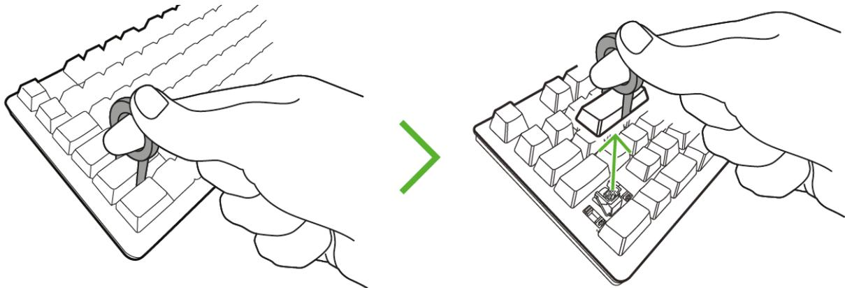
(Para teclas más grandes) Levanta con cuidado la tecla separada y, con ayuda de un destornillador plano (no incluido), retira cualquiera de los extremos curvos de la barra estabilizadora para soltar la tecla.
