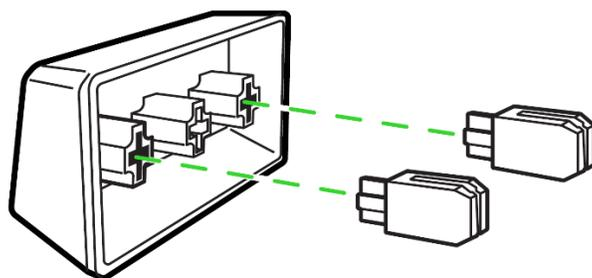
3. Presiona la tecla de PBT Razer hasta que quede colocada.
