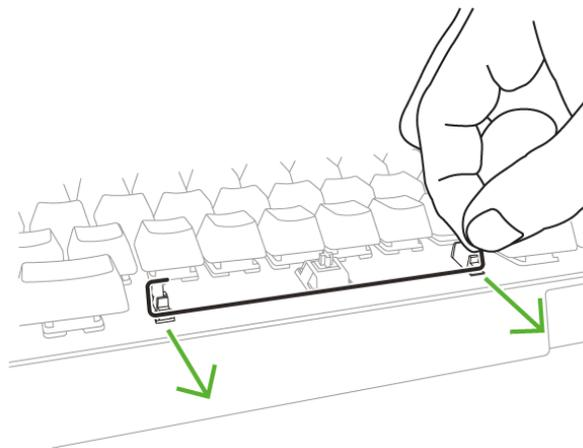
2. (Para teclas más grandes) Introduce los estabilizadores de teclado mecánico que necesitas en el vástago de la tecla de PBT Razer correspondiente.
