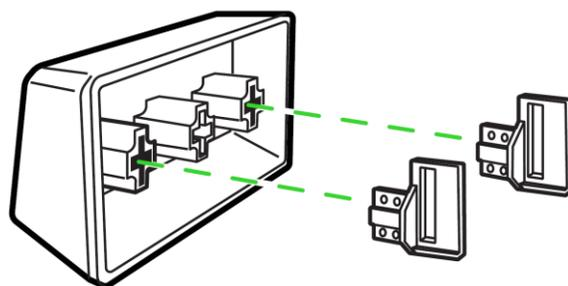
Para instalar la tecla de PBT Razer en la barra estabilizadora, introduce un extremo de la barra en el estabilizador, y ayúdate de un destornillador plano para empujar y enganchar el otro extremo en el estabilizador.
