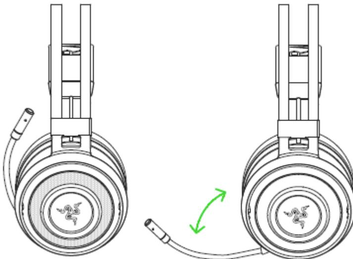
Dobla el micrófono hasta que quede situado frente a la boca y después ajusta la longitud como prefieras. Asegúrate de que el diafragma del micrófono quede situado frente a la boca y que el orificio de ventilación apunte en dirección opuesta a la boca.
