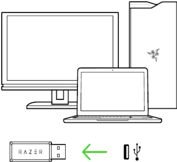
Paso 1: asegúrate de que el dispositivo Razer esté conectado al puerto USB del ordenador.
