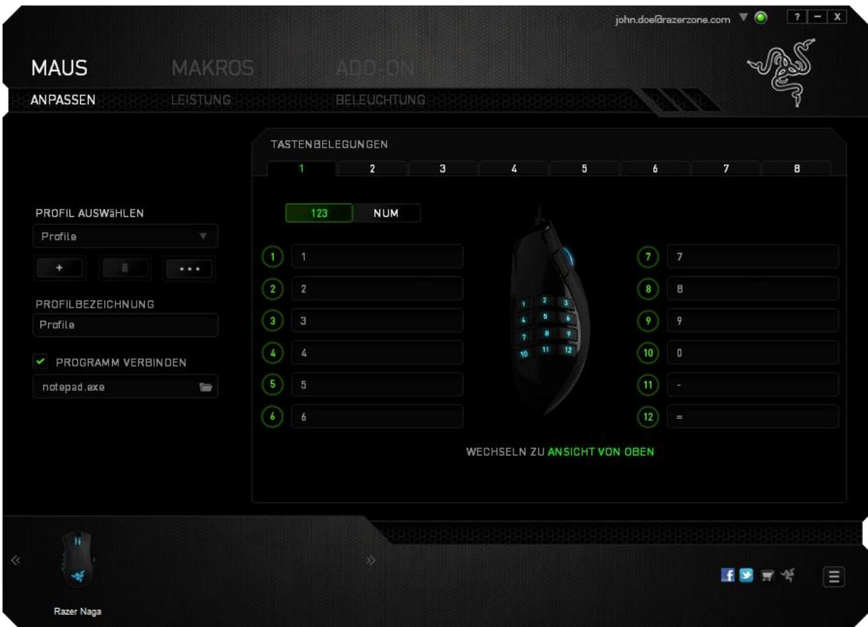
Verwende den Schalter in der Mitte des Bildschirms, um sowohl den einfachen [123] als auch den erweiterten [Num] Modus zu konfigurieren. Du musst den Schalter an der Unterseite der Razer Naga nicht umlegen, um die Tasten im Daumenbereich zu konfigurieren (egal welcher Modus aktiviert ist). Du benötigst den Schalter allerdings, um zwischen der einfachen [123] und der erweiterten [Num] Konfiguration zu wechseln.
