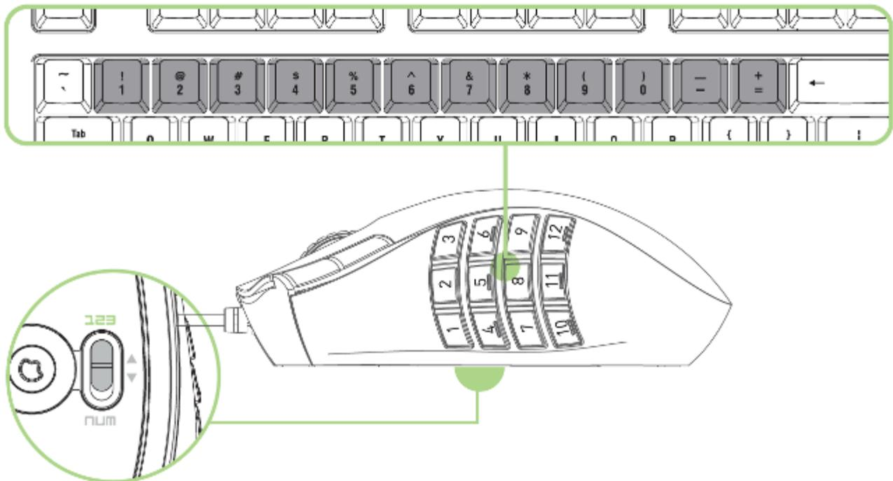
Im einfachen [123] Modus funktioniert das 12er Daumentastenfeld genauso wie die oberen Zahlentasten einer Tastatur. Mit diesen Tasten kannst du die Aktionsleiste der meisten MMO-Spiele auf die Tasten des Daumenbereichs übertragen.
