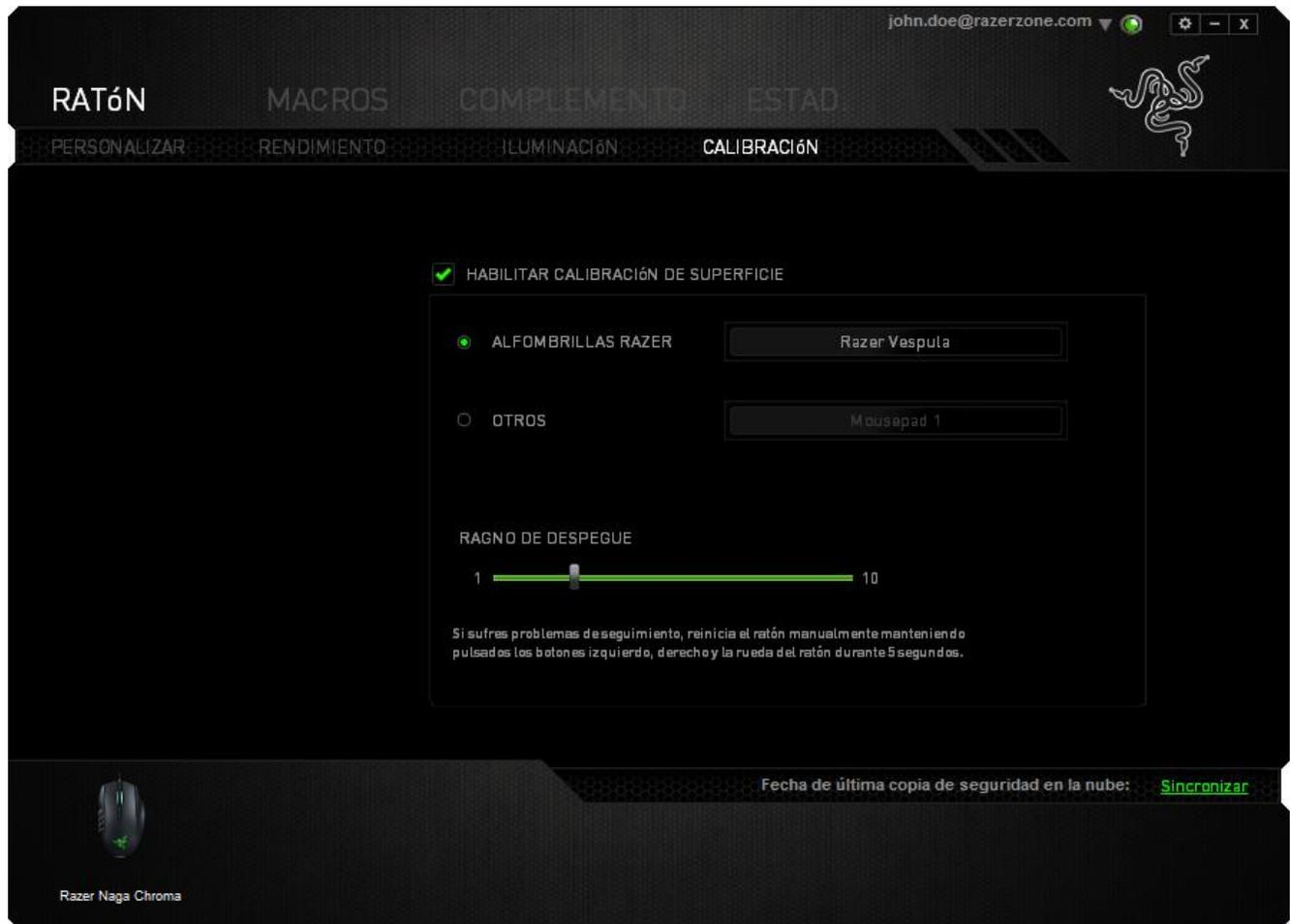
El RANGO DE ELEVACIÓN te permite configurar la distancia en la que el sensor detiene el rastreo cuando se mantiene alejado de la superficie para ratón. Para usar esta función, primero tendrás que activar la opción CALIBRACIÓN DE SUPERFICIE y, luego, elegir una superficie para ratón adecuada. Una vez activada la opción CALIBRACIÓN DE SUPERFICIE, tendrás que elegir la superficie para ratón que estás usando en este momento.
