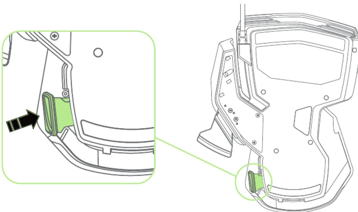
2. Desliza la mitad inferior de teclado en vertical para su ajuste.
