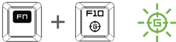
激活“游戏模式”允许你禁用 Windows 键，避免误按影响到游戏。此外，你还能通过 Razer Synapse 2.0 中的“游戏模式选项卡”，禁用 Alt + Tab 和 Alt + F4。此外，您还可以通过激活游戏模式功能来最大限度地提高按键防冲突的效果。开启此功能后，指示灯会亮起。
