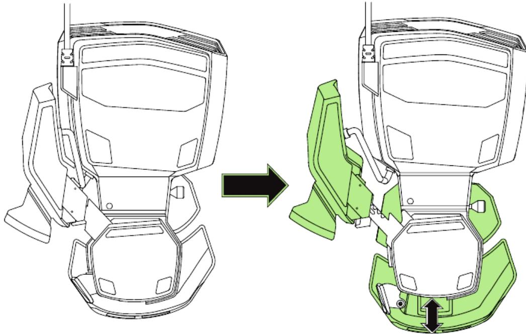
3. Schalter zum Fixieren des Daumenmoduls loslassen.
