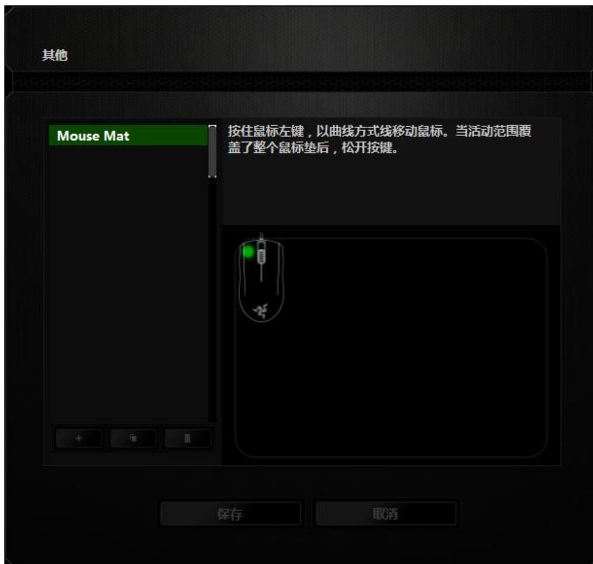
在整个鼠标移动表面上移动完毕后，释放左侧鼠标按键。此时您将返回手动校准子菜单，它包含有关您的鼠标移动表面的新信息。
