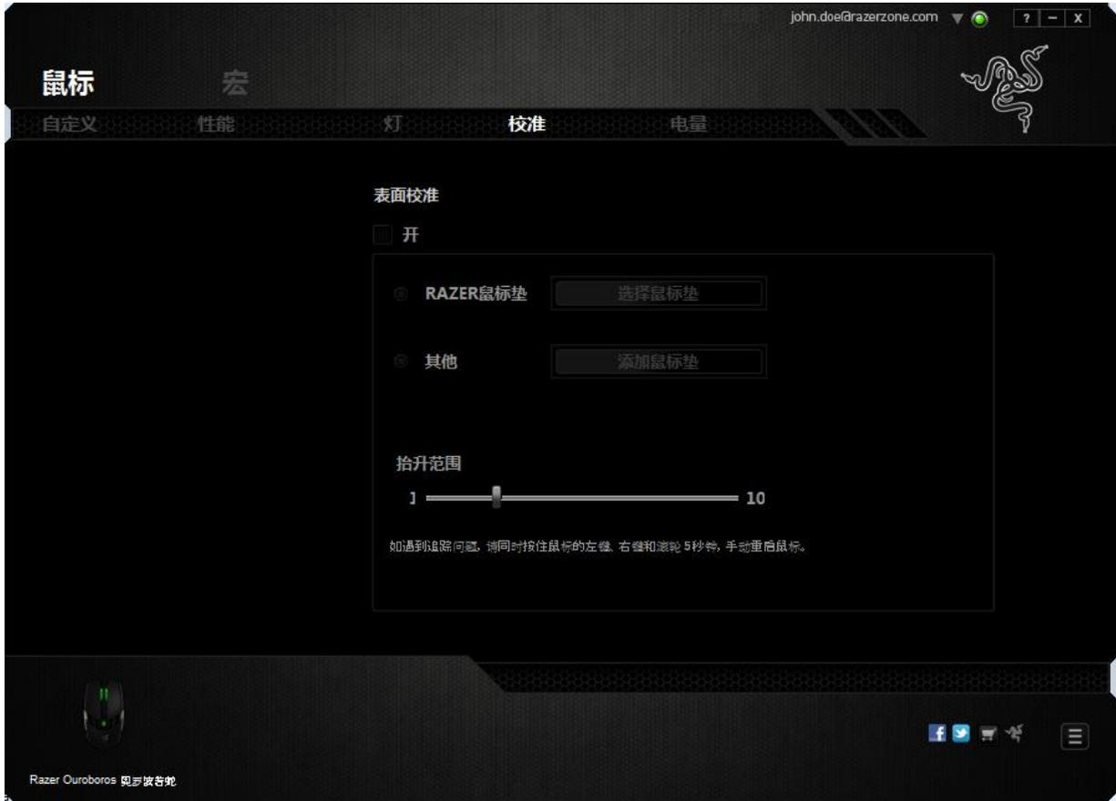
抬升距离允许您设置当传感器离开所在表面时中止追踪的距离。要使用此功能，您必须先激活表面校准，然后选择合适的鼠标移动表面。
